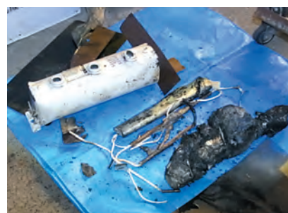
事故で飛散したコンデンサ部品
